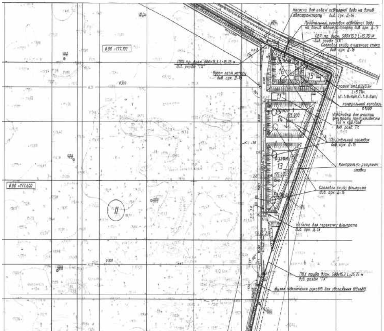
Рис. 21. Конструктивна схема очисних споруд фільтрату
